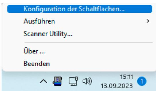
Im Scanner können Sie insgesamt neun vordefinierte Scan-Funktionen speichern. Diese werden über die Funktionstasten (+/-) am Gerät ausgewählt. Die angezeigte Ziffer bestimmt die gewählte Scan-Funktion. Die Konfiguration erfolgt über das Programm „Doc Action“, welches unten rechts in Ihrer Windows-Startleiste als Symbol angezeigt wird. Führen Sie einen Klick mit der rechten Maustaste aus und wählen Sie „Konfiguration der Schaltflächen“.
